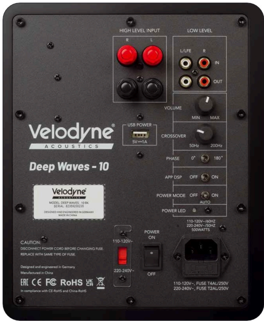
Hier sieht man die rückwärtigen Anschlussfelder der beiden Subwoofer nebeneinander im Vergleich. Dem Deep Waves 10 fehlen zwei Möglichkeiten ...
