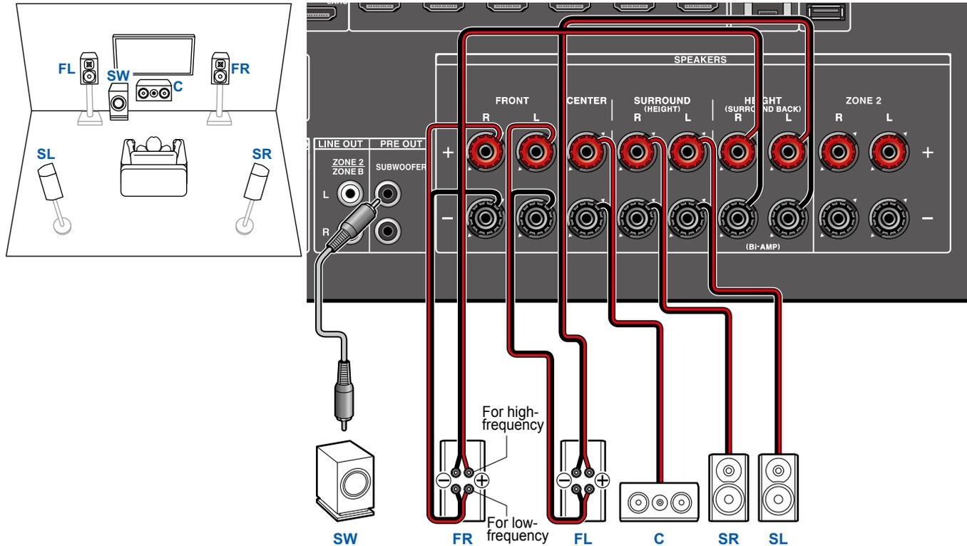
Stellen Sie sicher, dass die Leitungsbrücke zwischen den Tieftönerbuchsen und den Hochtönerbuchsen der Frontlautsprecher, die eine Bi-Amping-Verbindung unterstützen, entfernt werden. Entsprechende Informationen finden Sie auch in der Bedienungsanleitung Ihrer Lautsprecher.
