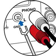
Wenn der Plattenspieler ein Erdungskabel hat, schließen Sie es an den GND-Anschluss an diesem Gerät an.
