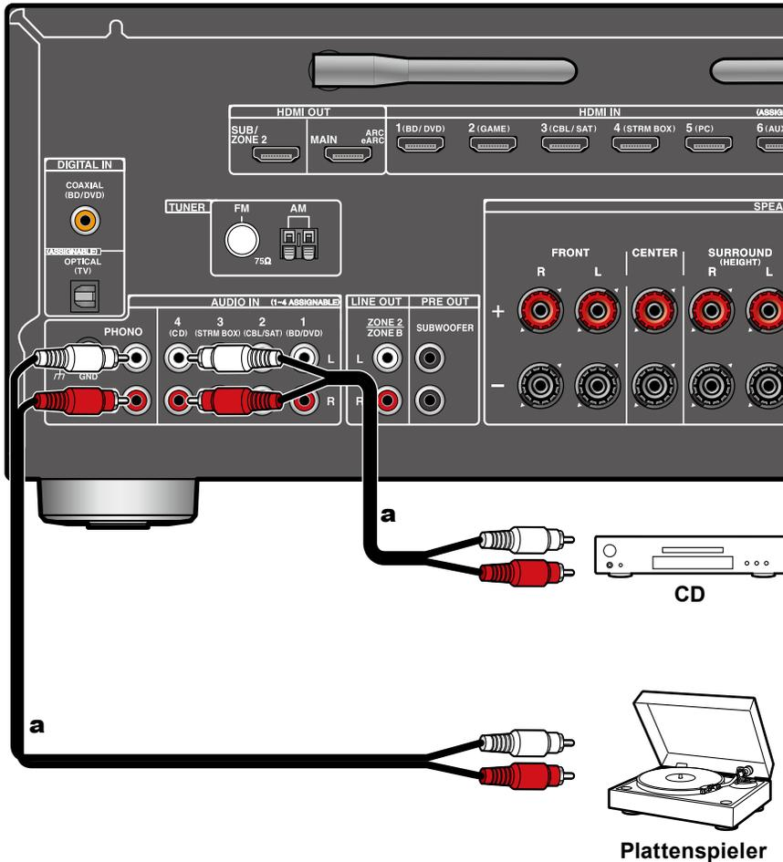
Dies ist eine Beispielverbindung mit einer Audiokomponente. Schließen Sie einen CD-Player mithilfe eines analogen Audiokabels an. Sie können auch einen Plattenspieler mit einem MM-Tonabnehmer an die PHONO-Buchse anschließen.
