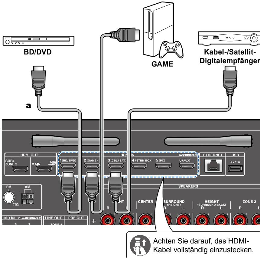
Dies ist eine Beispielverbindung mit einer AV-Komponente mit HDMI-Buchse. Wenn eine AV-Komponente angeschlossen wird, die dem CEC-Standard (Consumer Electronics Control) entspricht, können Funktionen wie die HDMI CEC-Funktion (\*), die mit Eingangselektoren usw. verknüpft ist, sowie die HDMI Standby Through-Funktion verwendet werden, mit der Video und Audio von AV-Komponenten auch dann zum Fernseher ausgegeben werden können, wenn dieses Gerät sich im Standby-Modus befindet.
