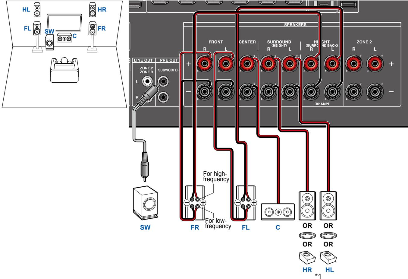
Stellen Sie sicher, dass die Leitungsbrücke zwischen den Tieftönerbuchsen und den Hochtönerbuchsen der Frontlautsprecher, die eine Bi-Amping-Verbindung unterstützen, entfernt werden. Entsprechende Informationen finden Sie auch in der Bedienungsanleitung Ihrer Lautsprecher.
