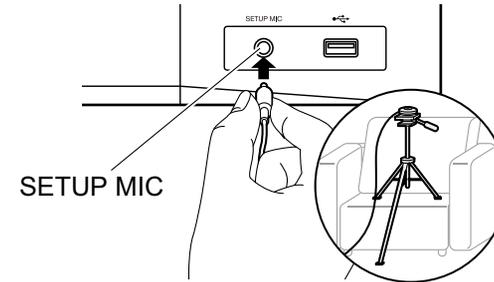
Wenn Sie das Messmikrofon zur Lautsprechereinrichtung auf einem Stativ platzieren, gehen Sie entsprechend der Abbildung vor.
