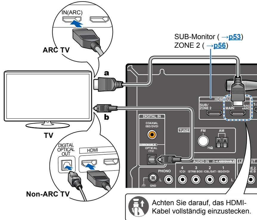
**a** HDMI-Kabel, **b** Digitales optisches Kabel
